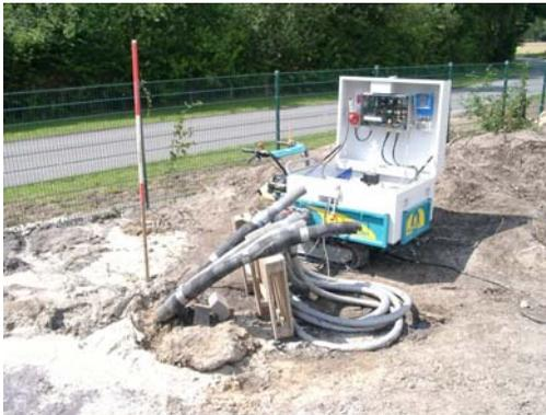
Abbildung 1: Geothermal-Response-Testgerät im Gelände und aufgezeichnete Temperaturen sowie abgegebene Heizleistung
