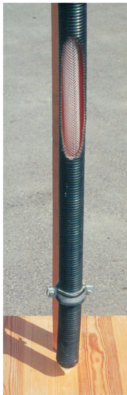
Abb. 4 Messe-Modell der Wellrohr-Sonde von Helmut Hund, Patentantrag DE 3139868 vom 7. Oktober 1981
