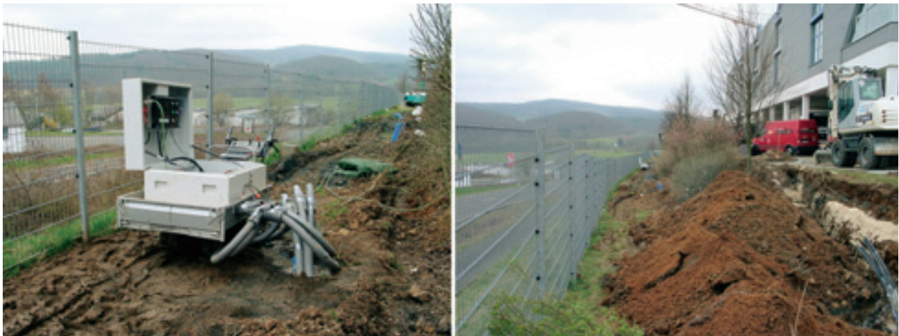
Abb. 6 Modernes Gerät für Geothermal Response Test, im Einsatz unter erschwerten Geländebedingungen
